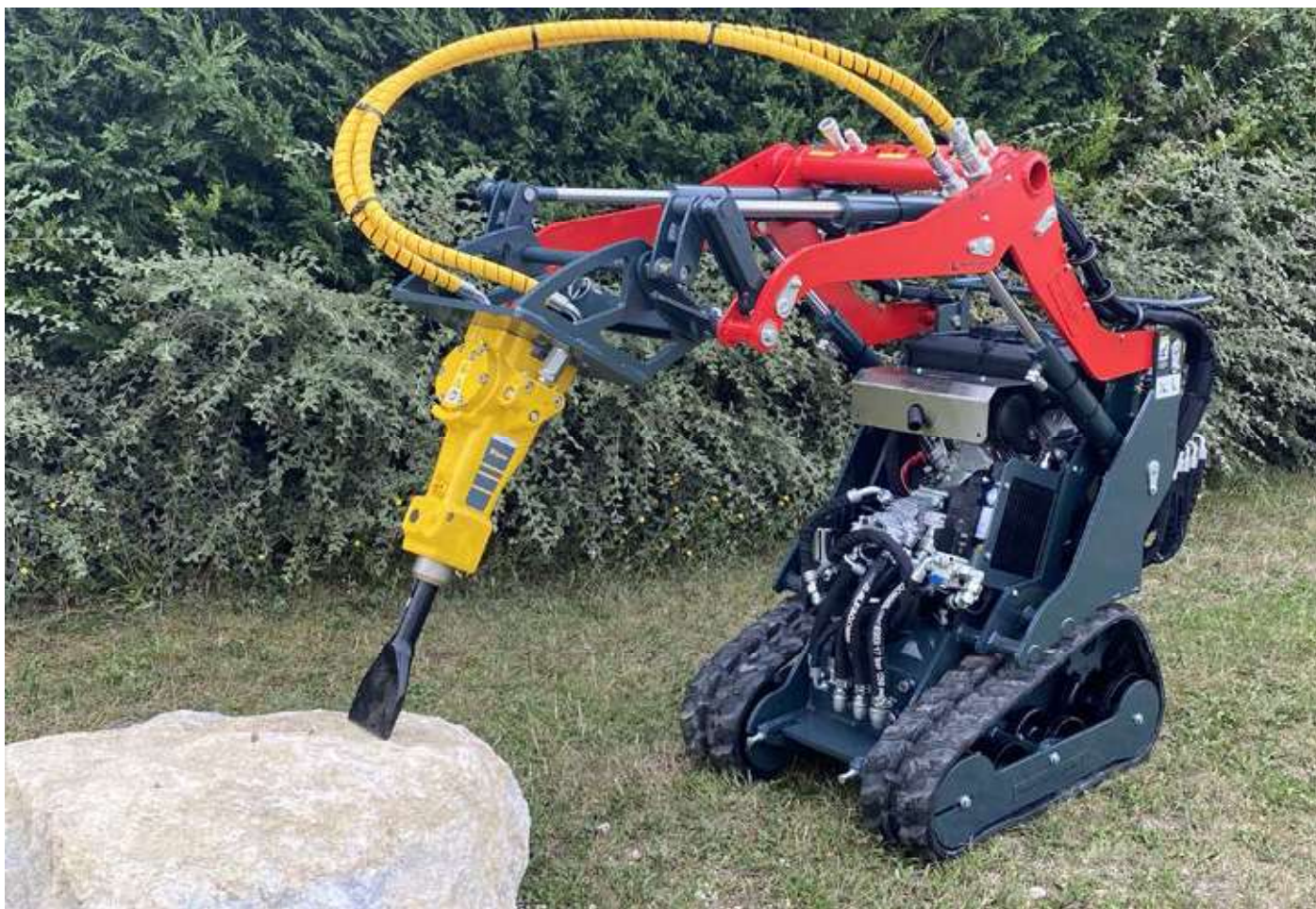
Brise Roche Hydraulique EPIROC® SB52 pour microBull PRO II, Réf : 00632
