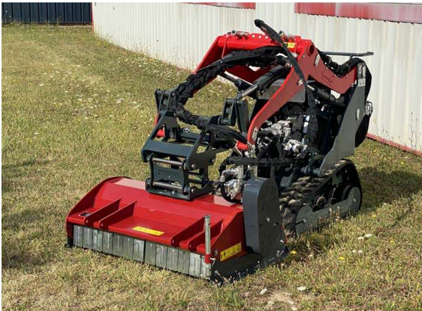
Broyeur MAJAR - largeur 100cm pour microBull PRO II 23CV, Réf : 00634
