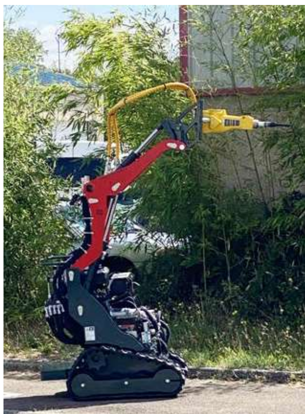
Brise Roche Hydraulique EPIROC® SB52 pour microBull PRO II, Réf : 00632
